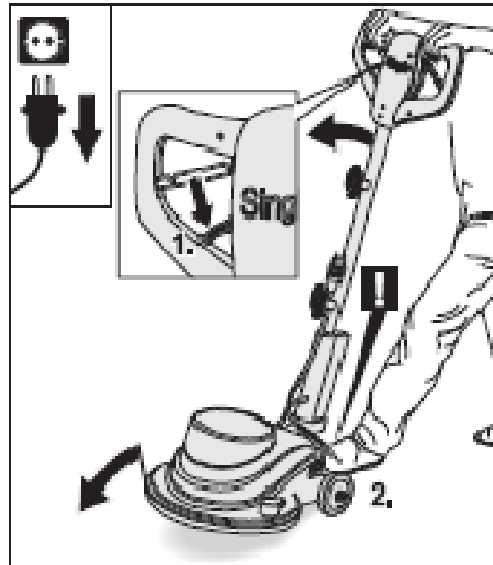
Rys. 6 Dźwignia musi znajdować się w dolnym położeniu (1). Następnie pchnąć maszynę do przodu zabezpieczając nogą (2).
