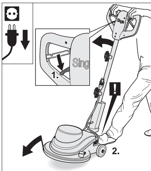
Abb. 6 Der Verstellhebel muss sich in der **unteren** Position befinden (1.). Dann die Maschine nach vorne kippen und gleichzeitig gegen das Wegrollen sichern (2.).
