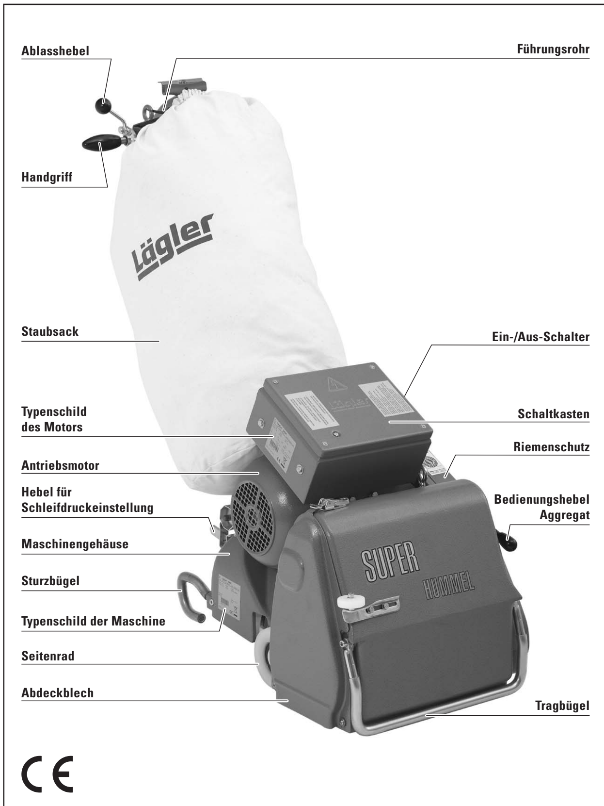
Abb. 1 Wichtige Teile und Baugruppen der Bandschleifmaschine SUPERHUMMEL
