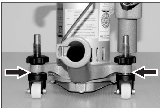
Abb. 68 Flache Maschineneinstellung für feine Schleifarbeiten.
