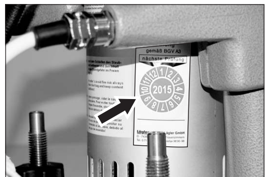
Abb. 81 Das Prüfsiegel am Motorgehäuse bescheinigt die elektrische und mechanische Sicherheit der Maschine und zeigt den nächsten fälligen Prüftermin an.
