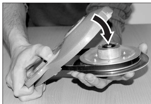
Abb. 42 Den kompletten Schleifteller mit dem Keilriemen in den Vorsatz einsetzen. Darauf achten, dass das Lochbild des kompletten Schleiftellers zum Lochbild des Vorsatzes fluchtet!
