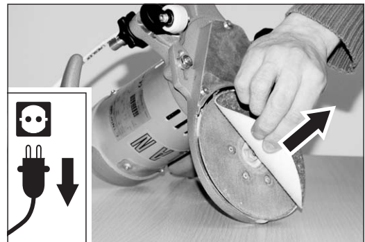
Abb. 16 Die Klettschleifscheibe vom Schleifteller abziehen.
