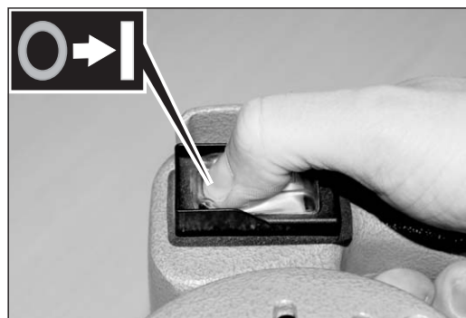
Abb. 11 Einschalten der Maschine am Wippenschalter.
