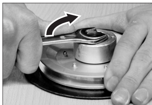
Abb. 54 Die Schleiftellerachse im Uhrzeigersinn (Linksgewinde) aus der Schleiftellerriemenscheibe schrauben.
