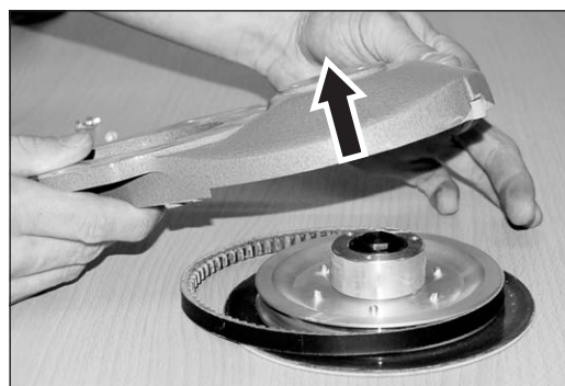
Abb. 50 Den Vorsatz von dem kompletten Schleifteller abnehmen.
