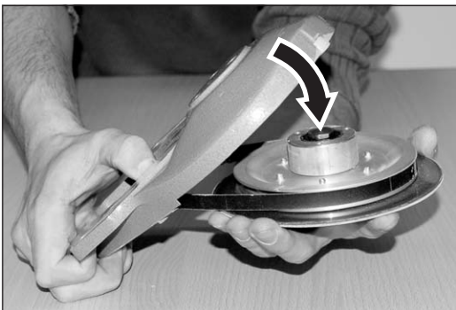
Abb. 51 Den kompletten Schleifteller mit dem Keilriemen in den Vorsatz einsetzen. Darauf achten, dass das Lochbild des kompletten Schleiftellers zum Lochbild des Vorsatzes fluchtet!
