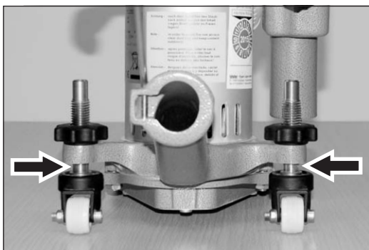
Abb. 70 Steile Maschineneinstellung für grobe Schleifarbeiten.
