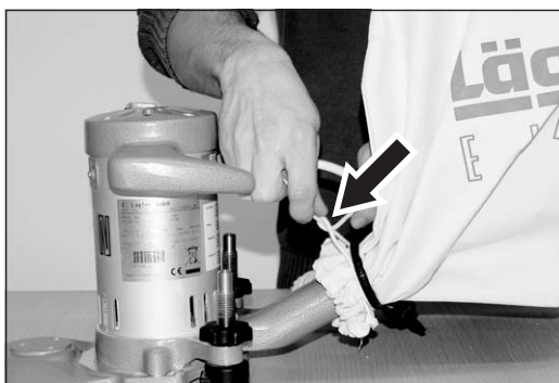
Abb. 7 Den Staubsack mit einer Schleife zubinden.
