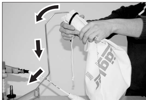
Abb. 6 Die Öffnung des Staubsacks zusammen mit dem MultiClip über den Sackhaltebügel und den Absaugstutzen am Ventilatorgehäuse schieben.
