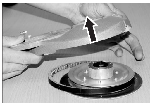
Abb. 40 Den Vorsatz von dem kompletten Schleifteller abnehmen.
