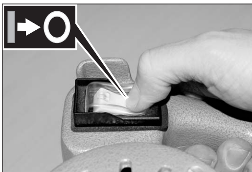
Abb. 12 Ausschalten der Maschine am Wippenschalter.
