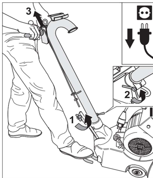
Rys. 56 Odkręcić śrubę motylkową na dyszlu podnoszącym (1) i nakrętkę motylkową na obudowie maszyny (2). Następnie wyciągnij rurę prowadzącą z obudowy maszyny (3).
