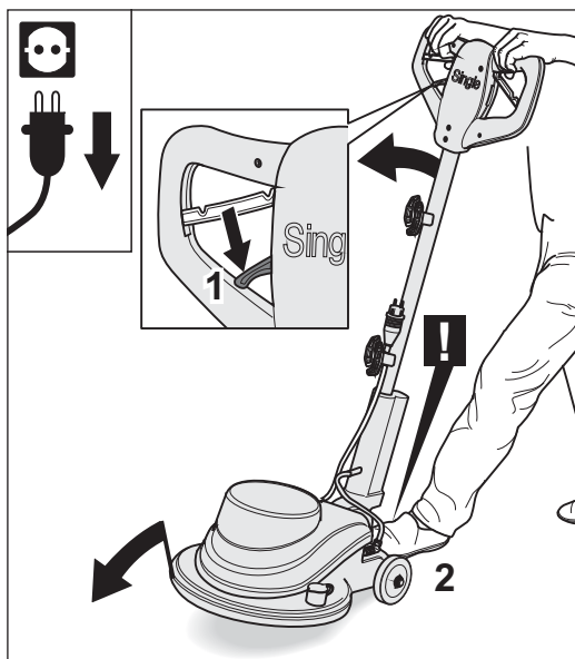
Abb. 22 Der Verstellhebel muss sich in der unteren Position befinden (1). Dann die Maschine nach vorne kippen und gleichzeitig gegen das Wegrollen sichern (2).
