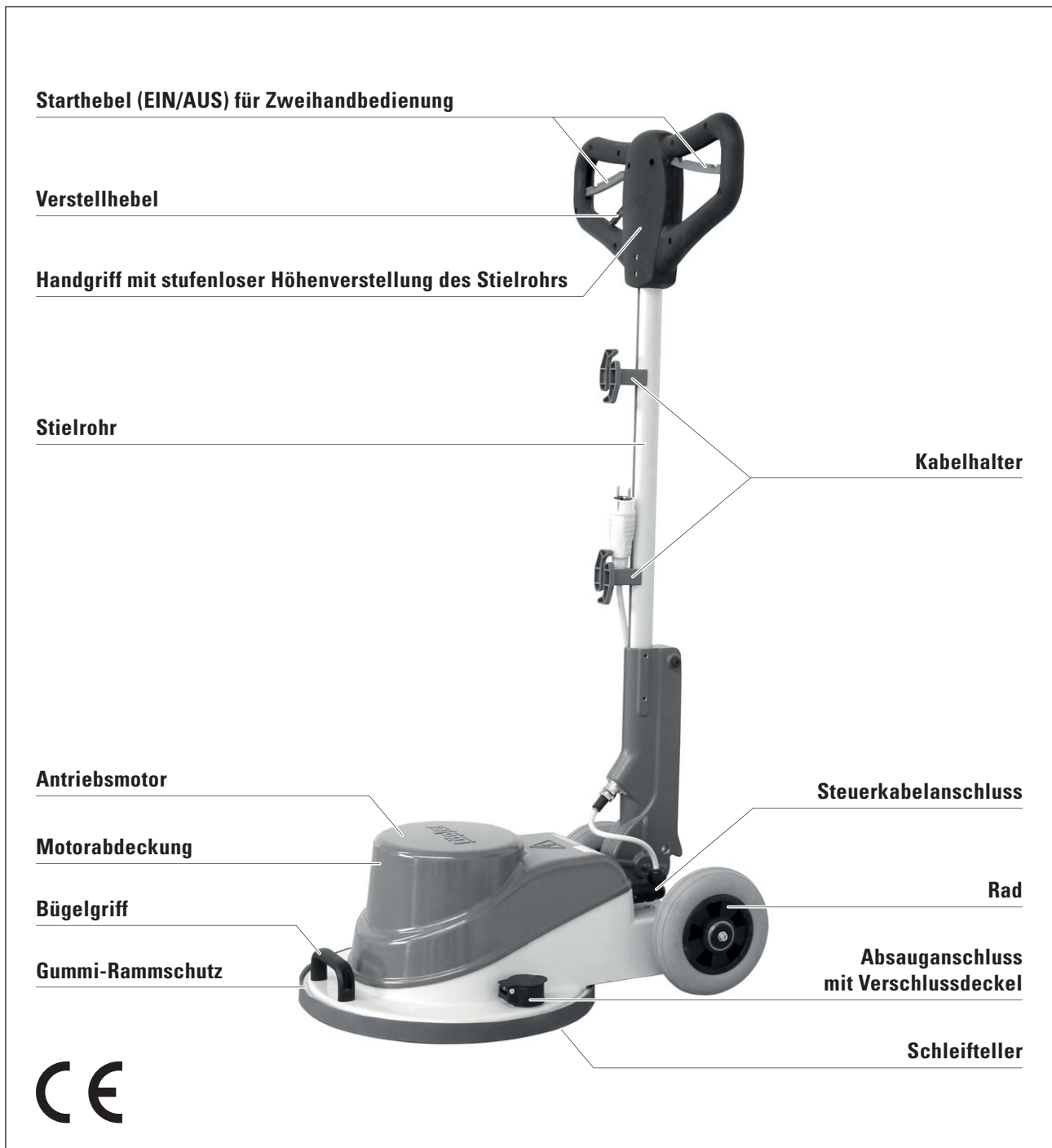
Abb. 1 Wichtige Teile und Baugruppen der Einscheibenschleifmaschine SINGLE.
