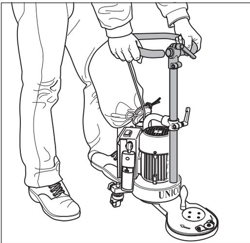
Abb. 45 Arbeiten mit der UNICO in gebückter Haltung mit Führungsrohr.
