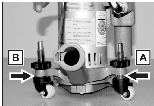
Abb. 79 Die Maschine schleift zu weit links : Die rechte Lenkrolle ( A ) hebt die Maschine weiter an als die linke Lenkrolle ( B ).
