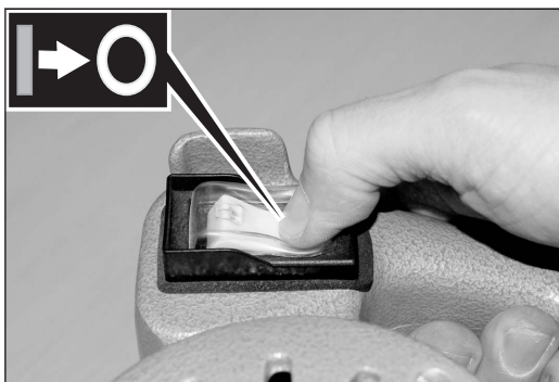
Abb. 12 Ausschalten der Maschine am Wippenschalter.
