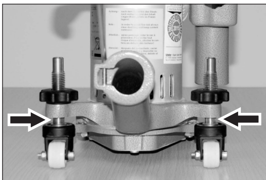
Abb. 70 Steile Maschineneinstellung für grobe Schleifarbeiten.
