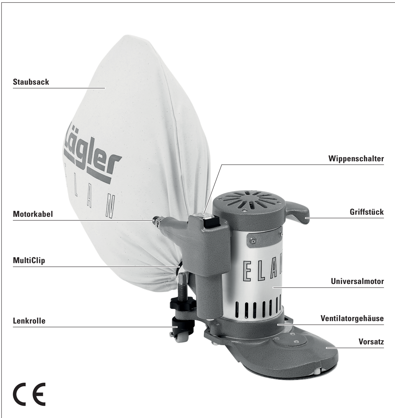
Abb. 1 Wichtige Teile und Baugruppen der Rand-, Treppen- und Eckenschleifmaschine ELAN
