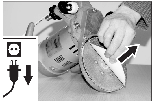
Abb. 21 Die Klettschleifscheibe vom Schleifteller abziehen.
