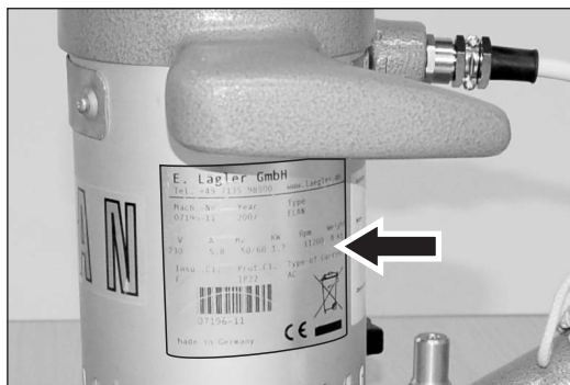
Abb. 2 Typenschild am Motorgehäuse.
