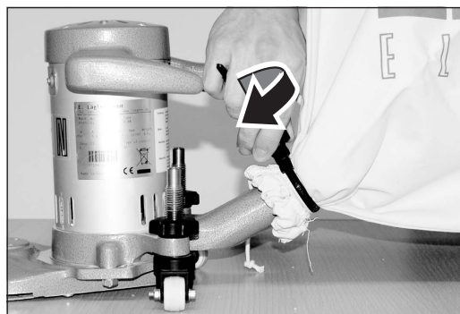
Abb. 8 Die Mutter am MultiClip handfest anziehen.
