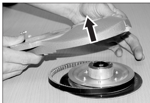
Abb. 40 Den Vorsatz von dem kompletten Schleifteller abnehmen.
