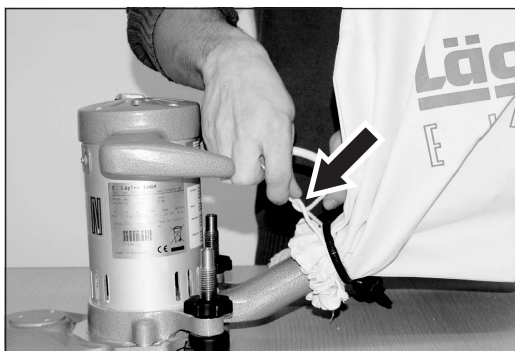
Abb. 7 Den Staubsack mit einer Schleife zubinden.
