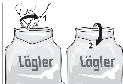
Abb. 51 Die Schutzfolie des Klebestreifens abziehen (1) und den Staubbeutel gut zukleben (2).
