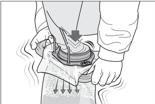
Abb. 28 Den Staubsack durch kräftiges Schütteln entleeren.
