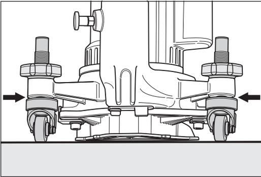
Abb. 64 **Flache** Maschineneinstellung für **feine** Schleifarbeiten.
