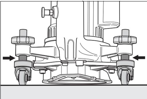
Abb. 66 **Steile** Maschineneinstellung für **grobe** Schleifarbeiten.
