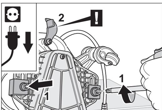
Abb. 47 Die beiden Schrauben zur Befestigung des Vorsatzes mit jeweils einer Scheibe und einem Führungswinkel in das Ventilatorgehäuse drehen (1). Darauf achten, dass sich das Riemenblech nicht zwischen dem Vorsatz und dem Ventilatorgehäuse befindet (2)!
