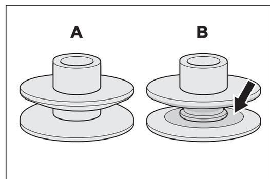
Abb. 48 **A:** Neue Motorriemenscheibe,
