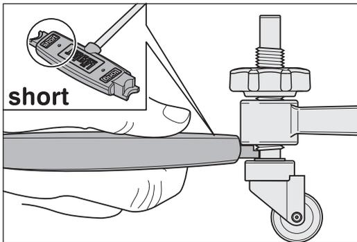
Abb. 57 StandardEinstellung für den **kurzen Vorsatz** und den **Eckenvorsatz**.
