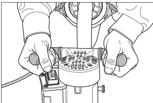
Abb. 11 Die FLIP® mit beiden Händen führen.
